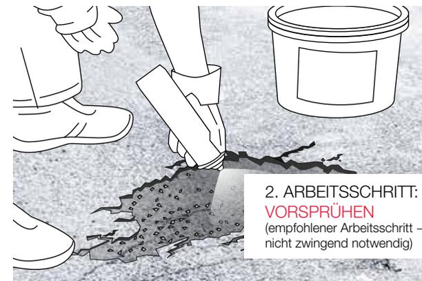
**EMPFEHLUNG:** Für maximale Haltbarkeit empfiehlt es sich die Einbaufläche mit einer bituminösen Grundierung, **EASYPHALT® PRIME**, zu behandeln.
