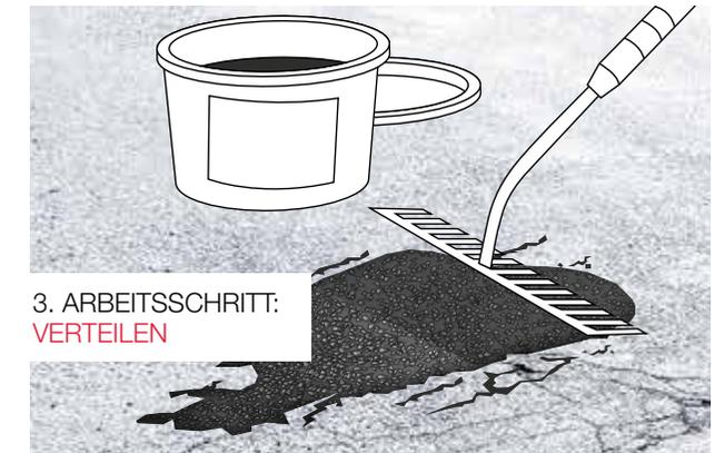
Die benötigte Menge **EASYPHALT®** leicht überhöht verteilen.
