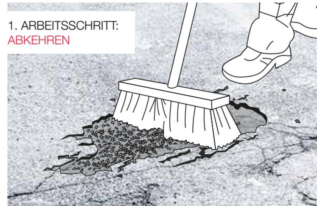
Vor dem Einbau sollte der Untergrund von Verschmutzungen gereinigt werden.
